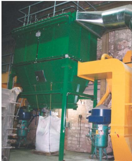
Patronenfilter für Sandstrahlanlage 40.000 m<sup>3</sup>/h
