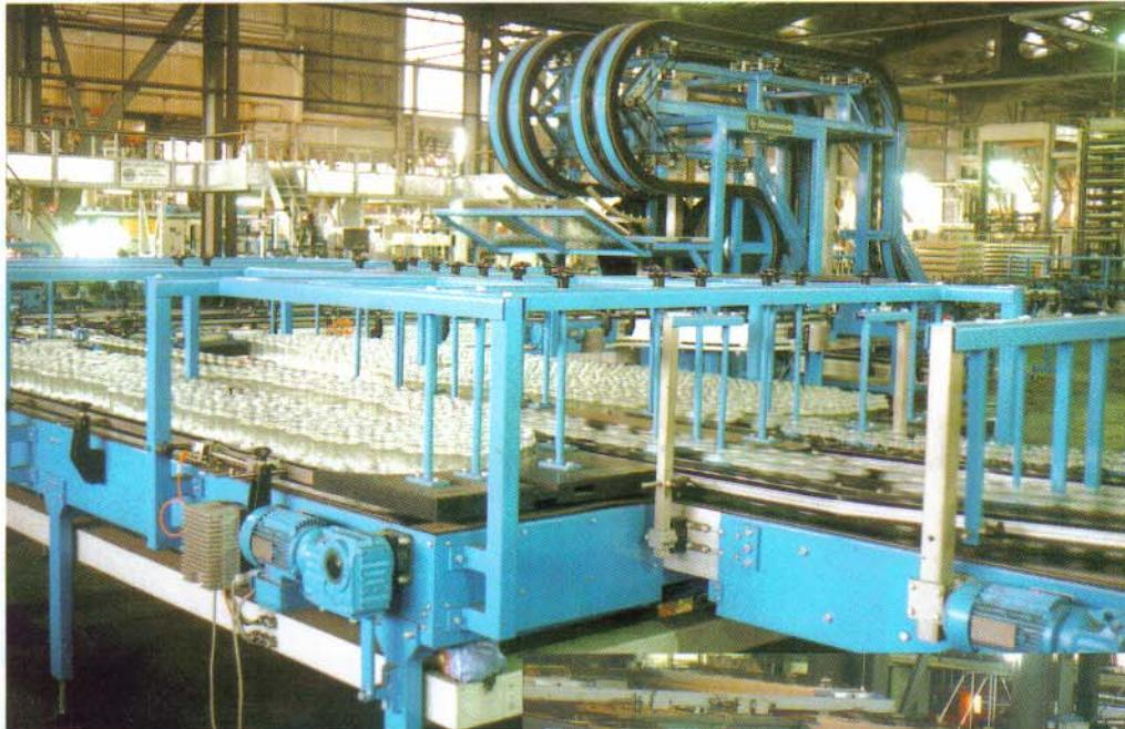
Verteiltsche zur individuellen Aufteilung auf mehrere Prüfstrände. Gegenläufig angeordnete Förderbahnen verhindern Staudruck und ermöglichen eine kurzfristige Zwischenpufferung.
